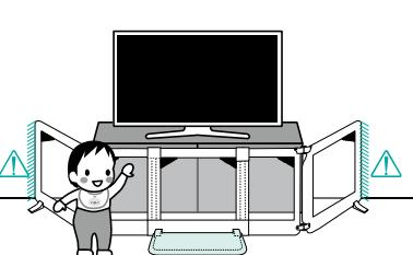
商品幅より広い間口では使用しないでください。本製品が背面側に倒れるおそれがあり大変危険です。必ずフェンスの両端が壁にかかるように設置してください。
