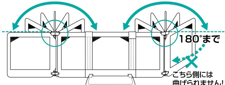
※フラップパネルは片側にのみ曲がる構造ですので、逆側には曲げないでください。破損の原因となります。
