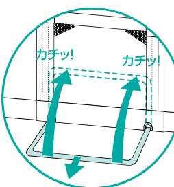
セーフティプレートを取り付けていない面のスタンドフレームを手前に引っ張りながら、「カチッ！」と音がするまで上方に持ち上げてください。
