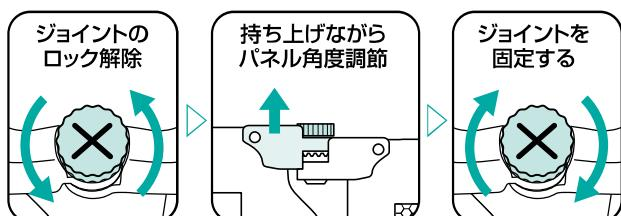
ジョイントロック(左右)のロックを解除し、上側のパネルを少し持ち上げながらフラップパネルの角度を調節し、再びジョイントを固定してください。
