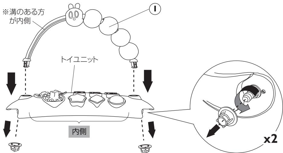
トイユニット裏側にセットされている固定用ネジを取り外してください。
