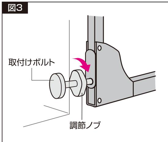
4. ゲイトが壁面と床面に対して直角であることを確認し、仮留めにしていたすべての調節ノブをしっかりと締めつけてください。特に下部の調節ノブはしっかりと締めつけ、固定してください。
