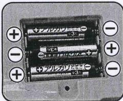
本体裏面のネジをプラスドライバーで外し、+−を間違えないように単3アルカリ乾電池を3本入れてください。電池セット後は必ずネジを締めてください。
