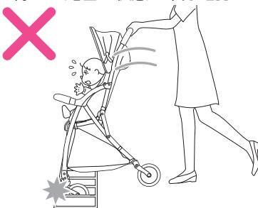
車輪が溝に挟まったときは、挟まった車輪の脚パイプとハンドルを持って、車輪を引き抜いてください。
