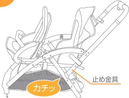
3.止め金具が力チツと固定し、本体が確実に固定されていることを必ず確認して下さい。
