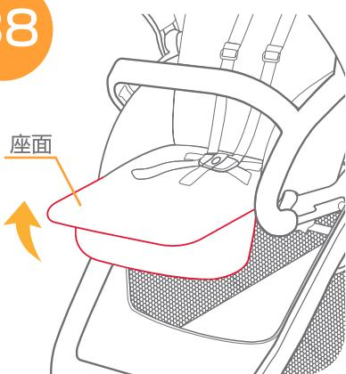
38.座面の角度をあげる場合は、座面を持ち上げて下さい。(2段階調節)
