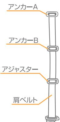
37.大きなお子様には、肩ベルトのアンカーAを一番上の肩ベルト穴に通して背もたれの後部から出して下さい。小さなお子様には、肩ベルトのアンカーBを一番下の肩ベルト穴に通して背もたれの後部から出して下さい。
