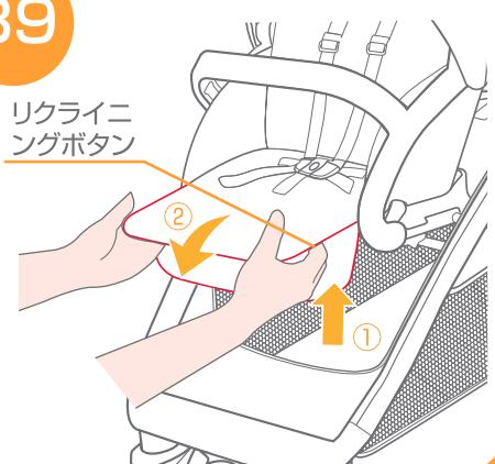
39.座面を下げる場合は、①座面の両側にあるリクライニングボタンを押しながら、②座面を下げて下さい。
