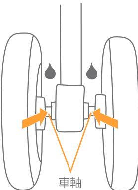
54.前輪・後輪の車輪の動きが悪い場合は、油等を車軸に注して下さい。
