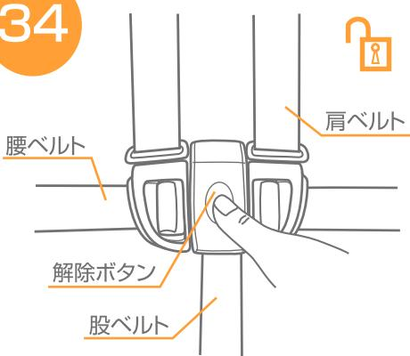
34.シートベルトを取り外す場合は、股ベルトの解除ボタンを押して、腰ベルトと肩ベルトを取り外して下さい。
