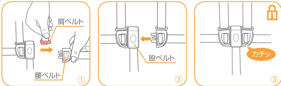
36.シートベルトを取り付ける場合は、①肩ベルトを腰ベルトに通し、②股ベルトに差し込んで下さい。
