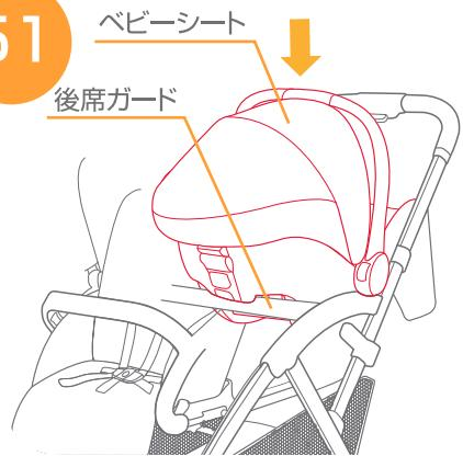
51.後席の背もたれを最も倒した状態にして、ベビーシートを後席ガードの上に取り付けて下さい。
