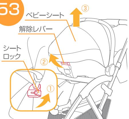
53.ベビーシートを取り外す場合は、①シートロックを引っ掛け、②ベビーシートの解除レバーを上げて、③ベビーシートを取り外して下さい。
