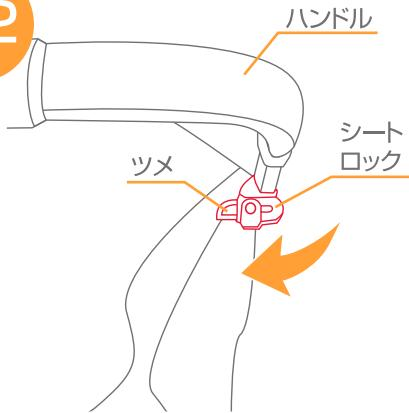
52.ハンドルに付いているシートロックを回してツメを出して下さい。※ベビーシートを取り付ける場合は必ずシートロックのツメを出して下さい。
