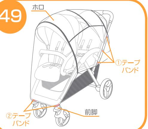
49.レインカバーを取り付ける場合は、本体のホロを開き、ホロにレインカバーをかぶせて、①両側にあるテープバンド(計6箇所)を固定して下さい。②両側の前脚にテープバンドを巻いて固定して下さい。
