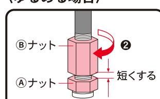
① 下側のⒶナットを反時計回りに回してゆるめる。
