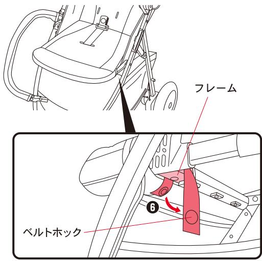
⑥ベルトホックを外し、フレームから抜き取る。
