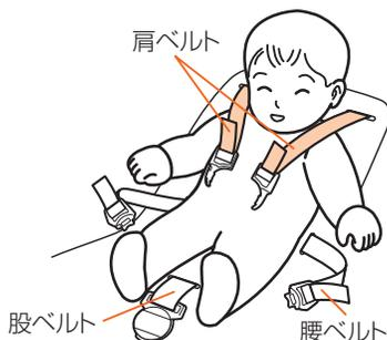
3. 股バックルを引き出し、股バックルの左右に重ねた肩と腰バックルを差し込み、「カチッ」と音がることを確認する。
