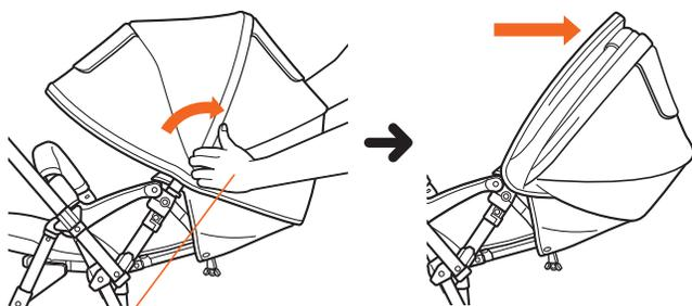
後幌フレームの根元部分を両手で持ち動かします。
