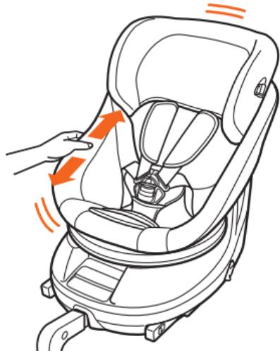
「回転」および「リクライニング」操作後には、レバーが「カチッ」と音がして、元の位置に戻り、シート部がロックされていることを確認してください。シート部がロックされていない状態で使用しないでください。
