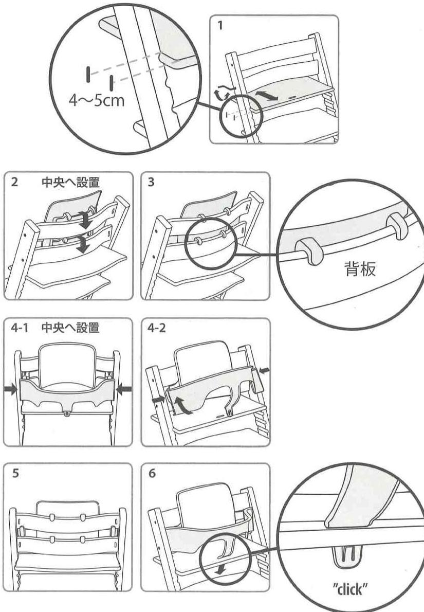
**1** 座板を1段目の溝にはめ込み、左図のように座板の位置(前後)を調節してください。
