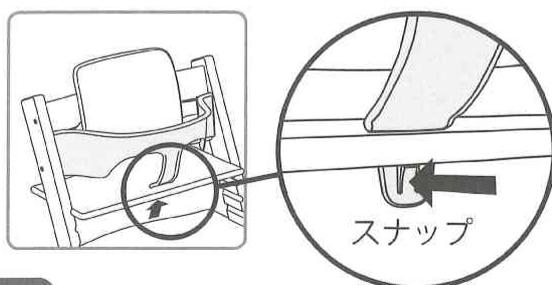
**1** 左図のスナップのロック部分を押しながら、座板の穴に通して、レール(ガード)を取り外してください。
